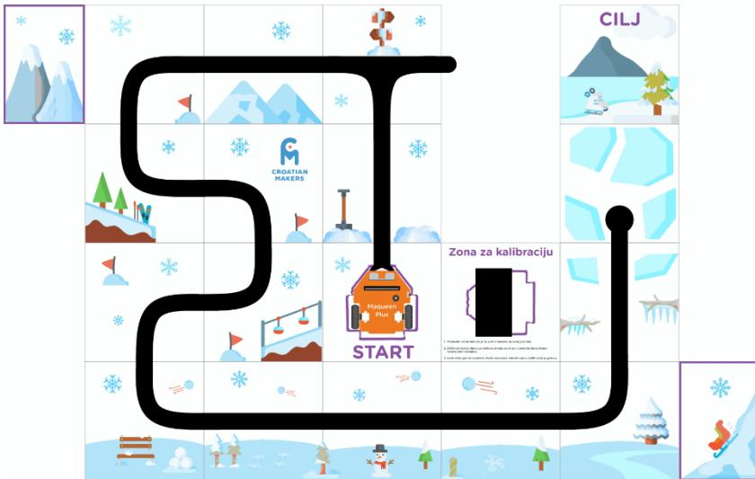
Postavi robot na poziciju **START** kako je prikazano na slici (unutar obrisa, sa sva tri kotača unutar kvadrata) tako da s prednjim senzorima za praćenje linije bude na crnoj podlozi te ima isključene svjetleće diode. Robot mora praćenjem linije obići sve snježne aktivnosti, detektirati sve prepreke na putu i uspješno stići do **CILJA**.
