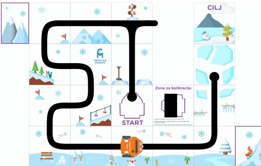
Robot prati liniju sve dok ultrazvučnim senzorom ne detektira prepreku postavljenu na označeno mjesto (polje sa slikom sanjki).
