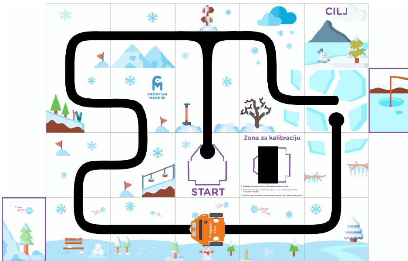
Robot prati liniju sve dok ultrazvučnim senzorom ne detektira prepreku postavljenu na označeno mjesto (polje sa slikom bora i snježne grude).
