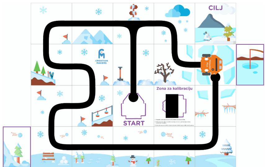
S isključenim svjetlima zakreće se ulijevo prema CILJU. Robot vozi ravno do CILJA i zaustavlja se kako je prikazano na slici (sa sva tri kotača unutar kvadrata).
